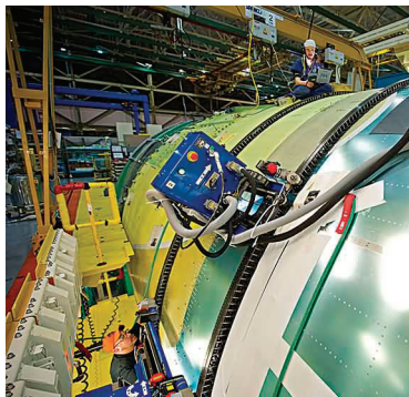
图10 旋转式自动换刀装置 Fig.10 Rotary auto tool changer
