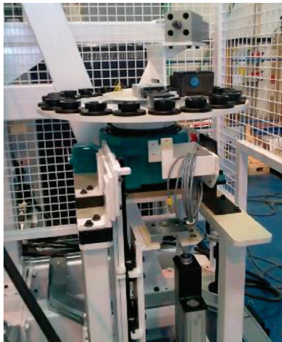
图10 旋转式自动换刀装置 Fig.10 Rotary auto tool changer
